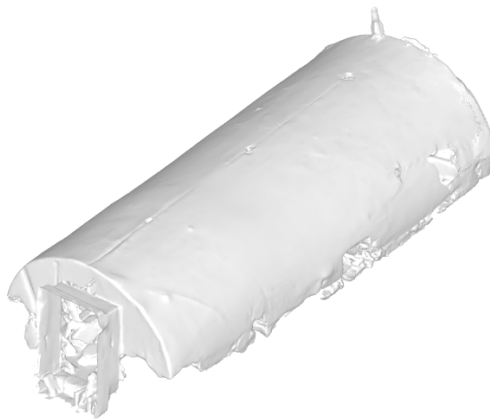
Bild 6: Vermessung der Gewölbetonne Sonneberg Biergarten (Länge Hauptgewölbetonnen=10 m, Oberfläche 160 m 2 )
