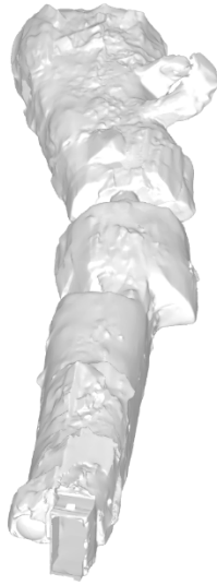
Bild 5: Vermessung der Hohlräume de Garküche Leutenberg (Länge Hauptgewölbetonnen=25 m, Oberfläche 316 m 2 )
